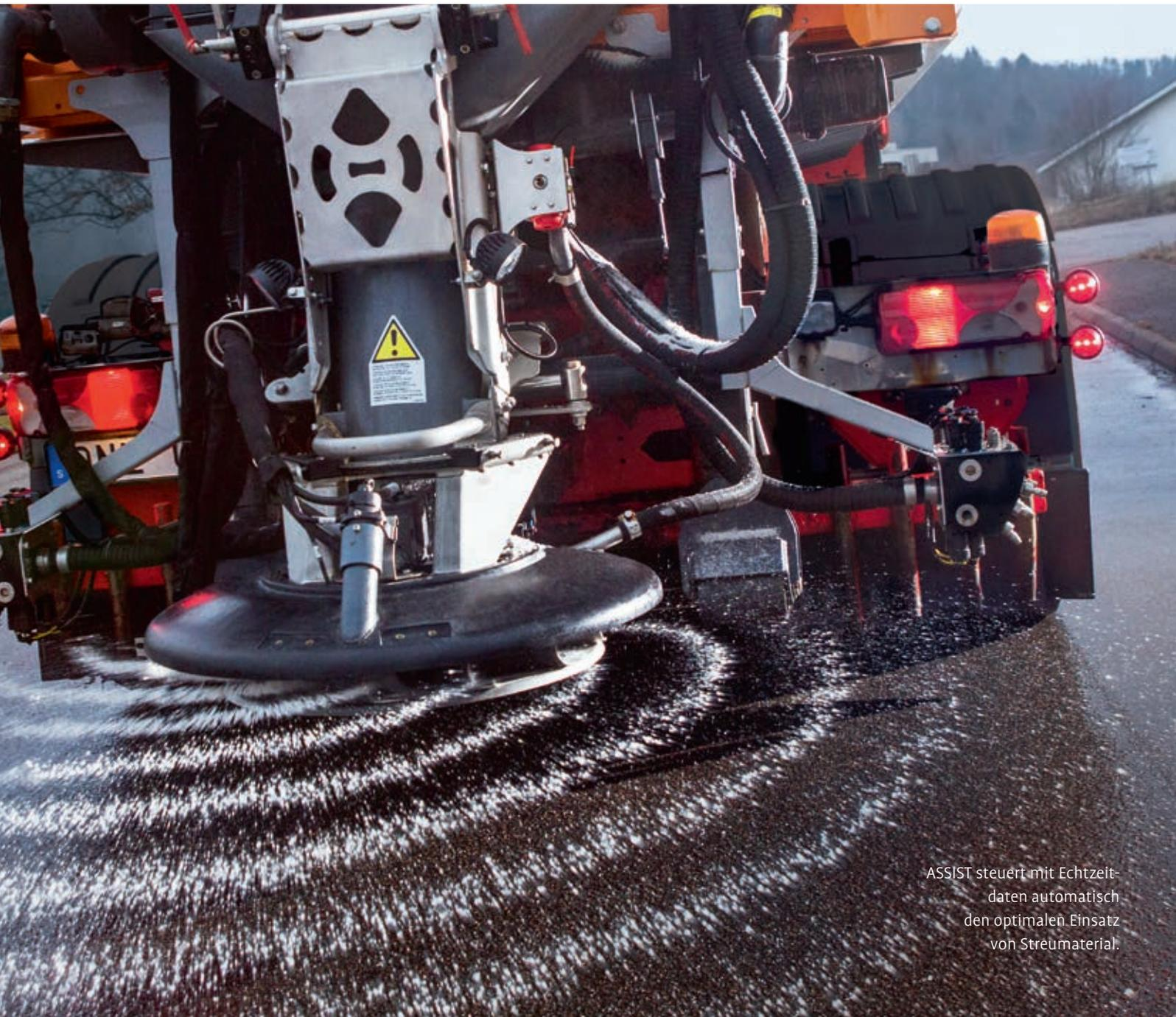
ASSIST steuert mit Echtzeitdaten automatisch den optimalen Einsatz von Streumaterial.
