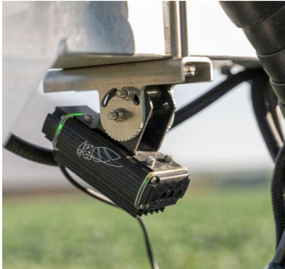
«Kuhn I-Spray» erkennt durch Sensoren Unkraut, um es effizient und präzise zu bekämpfen.
