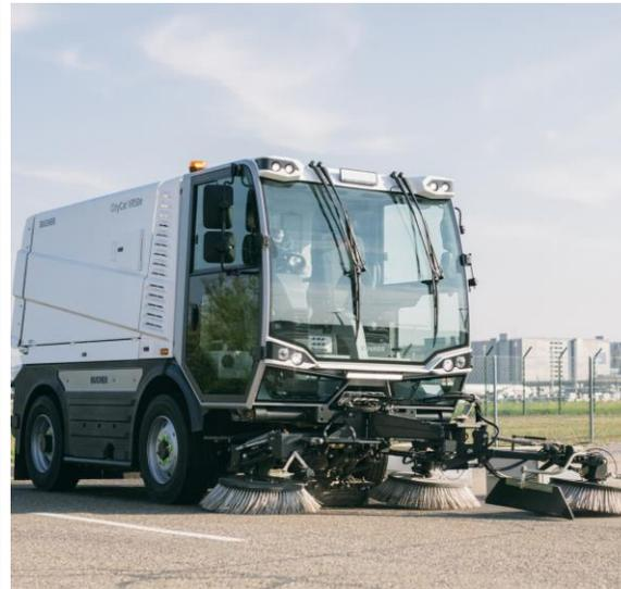
«CityCat VR50e» ist mit elektrischem Antriebsstrang und speziell entwickeltem Batteriepaket ausgestattet
